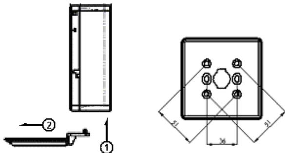
Pour son installation, fixez le boîtier du déclencheur sur le mur à l'aide de 2 vis en utilisant les orifices de fixation prévus à cette fin, en introduisant les câbles de connexion par l'orifice situé dans la partie centrale du boîtier. Avant d'installer le déclencheur, il est nécessaire de le codifier comme indiqué à la dernière page.
